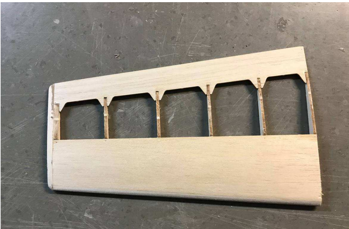
Außenflügel grob verschliffen
