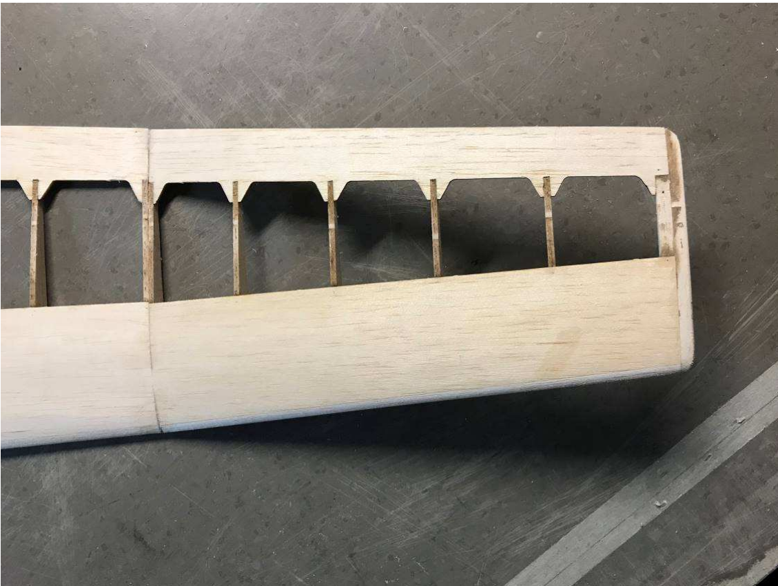
Verklebter Außenbereich von oben
