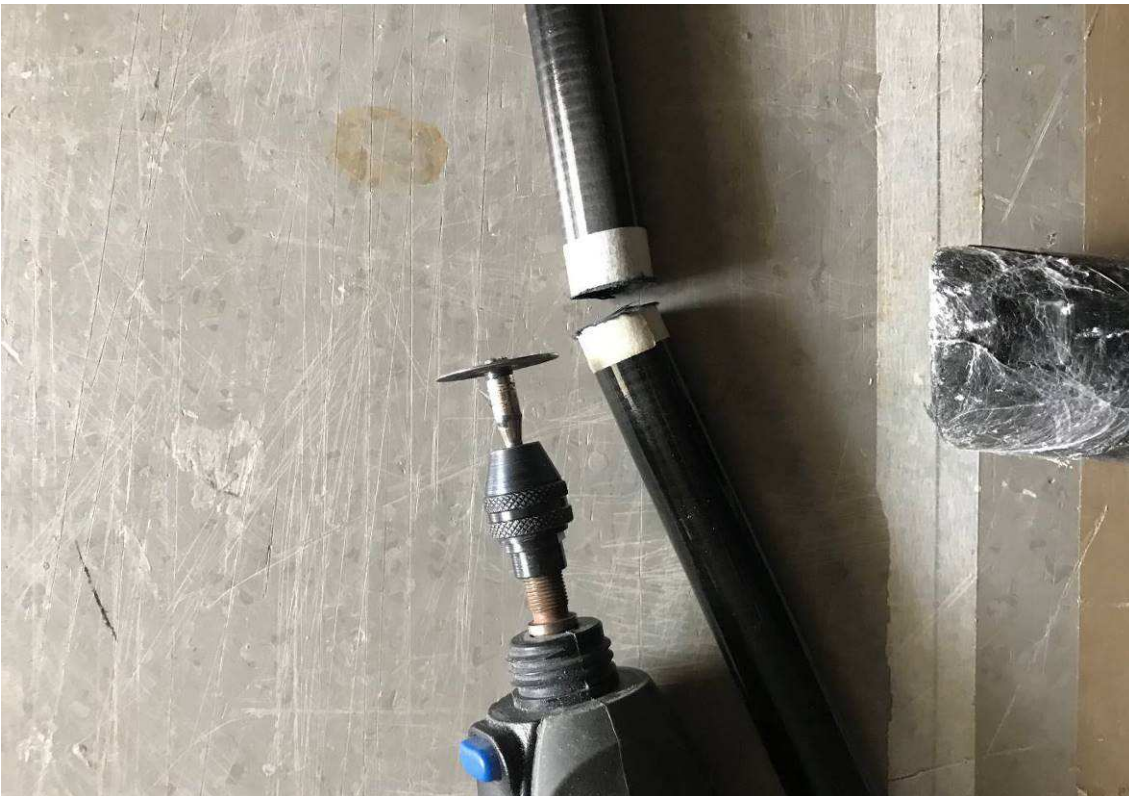
Rumpfrohr auf 660 mm am vorderen dickeren Ende kürzen
