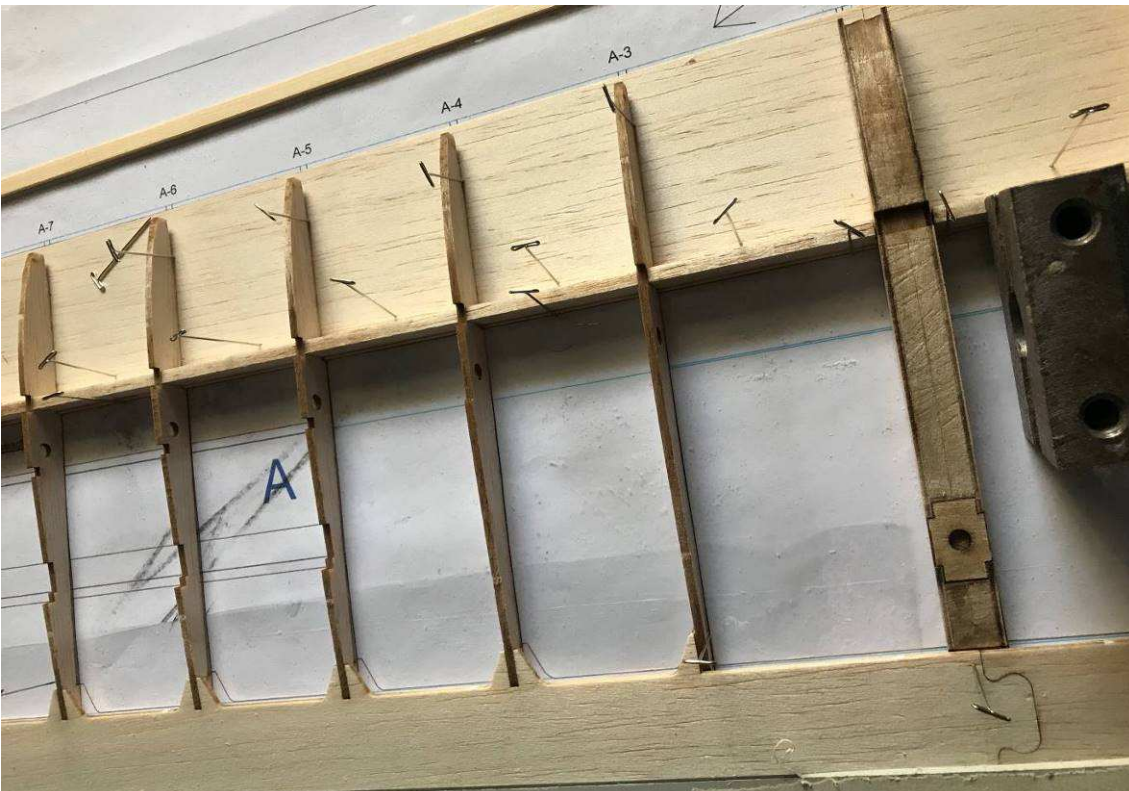
Bauteile fixiert und zum verkleben vorbereitet
