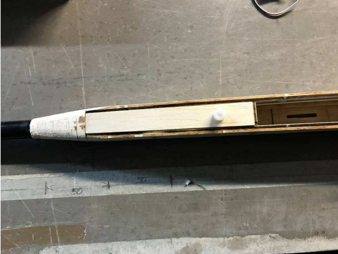
Verschliffener Übergang Rumpf- Rumpfrohr
