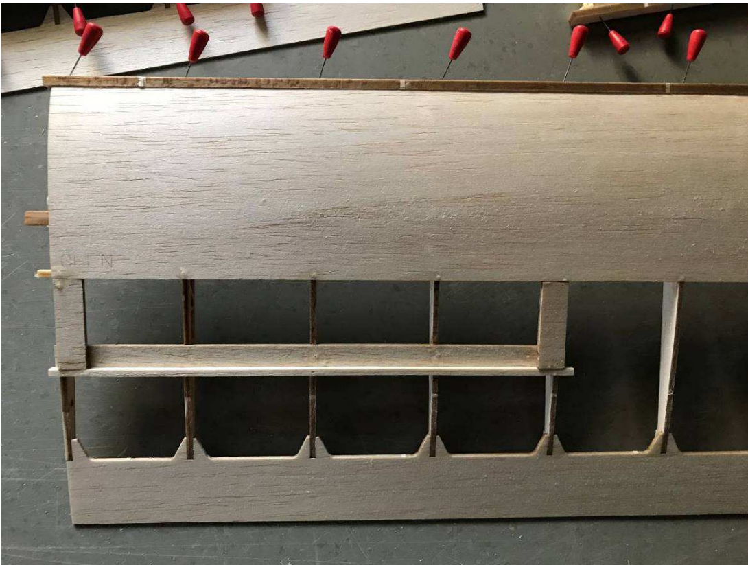
Angeklebte und fixierte Nasenleiste
