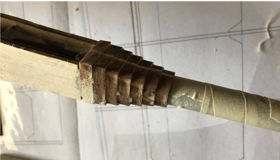
Rumpfrohrverkleidungen vor dem Verschleifen
