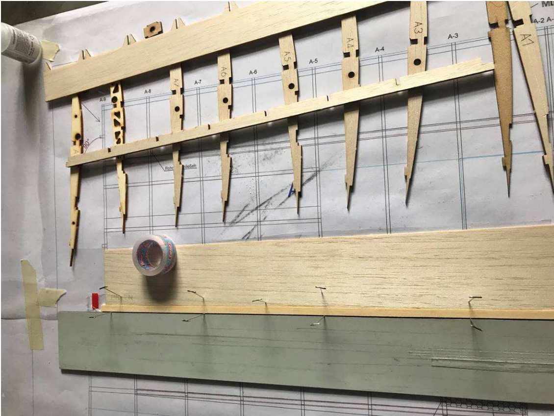
Verklebung unterer Holmgurt mit Beplankung (unten)
