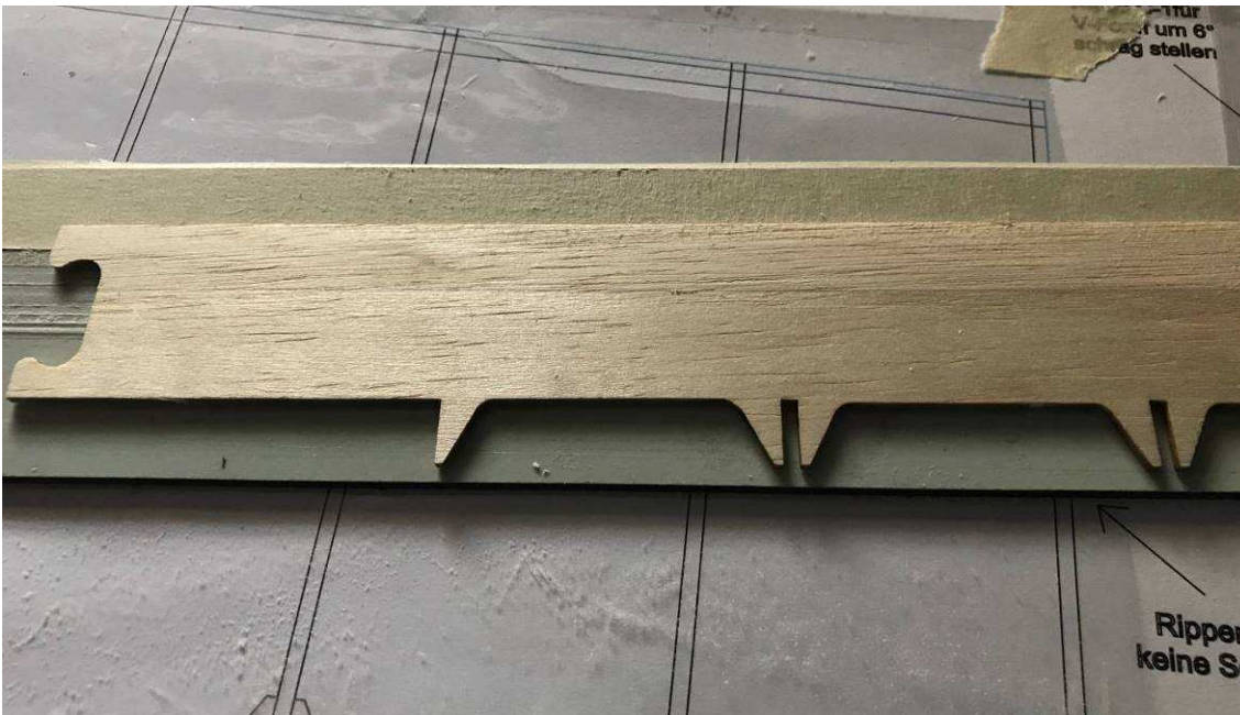
Endleiste fertig verschliffen
