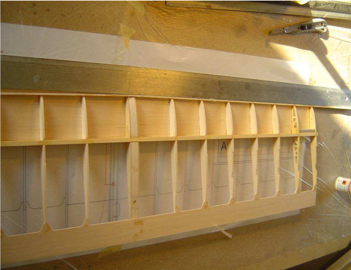
Verkleben der Hilfsnasenleiste mit Lineal an die Rippen
