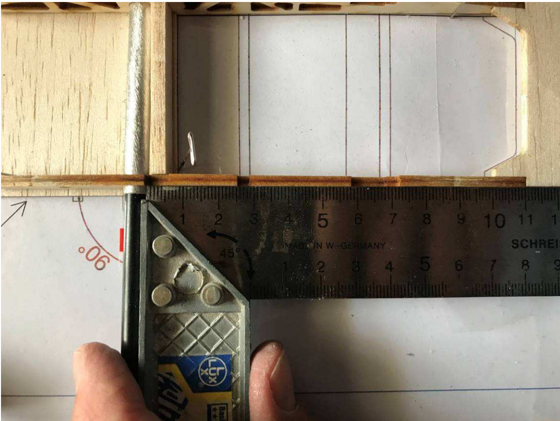
Ausrichten der Steckung
