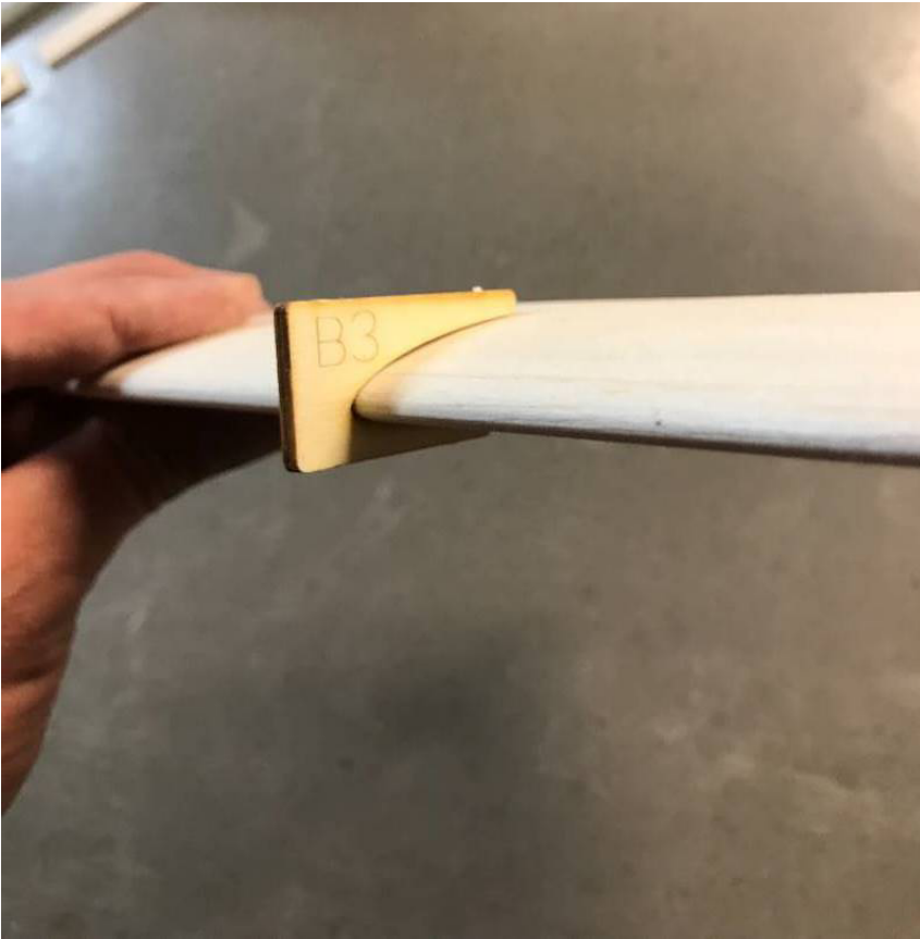
Verschleifen der Nasenleiste und Kontrolle mit Schablone
