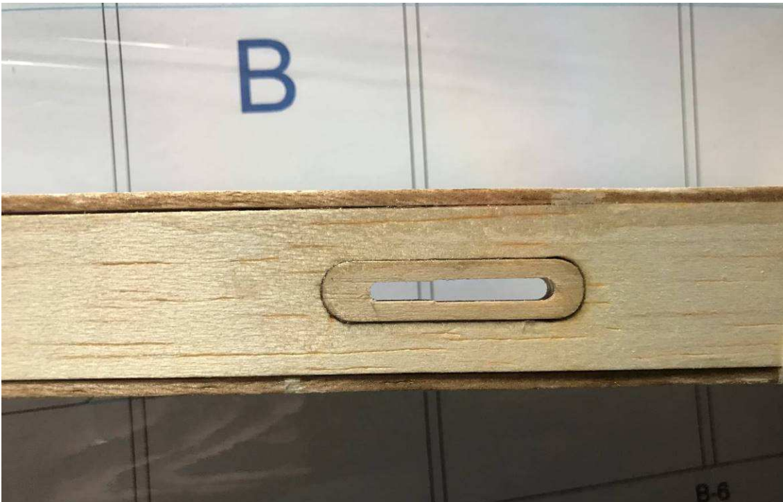
Hochstarthaken (temporär zerlegt und in Rumpfboden eingeklebt)
