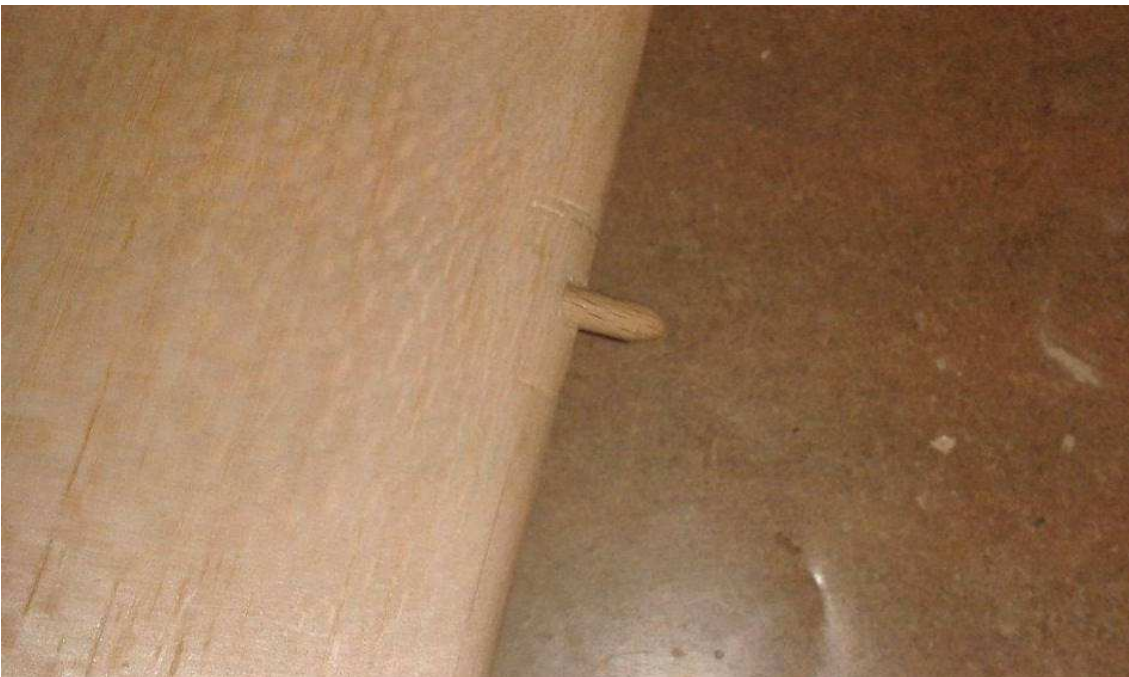
Eingeklebter Befestigungsdübel der Fläche
