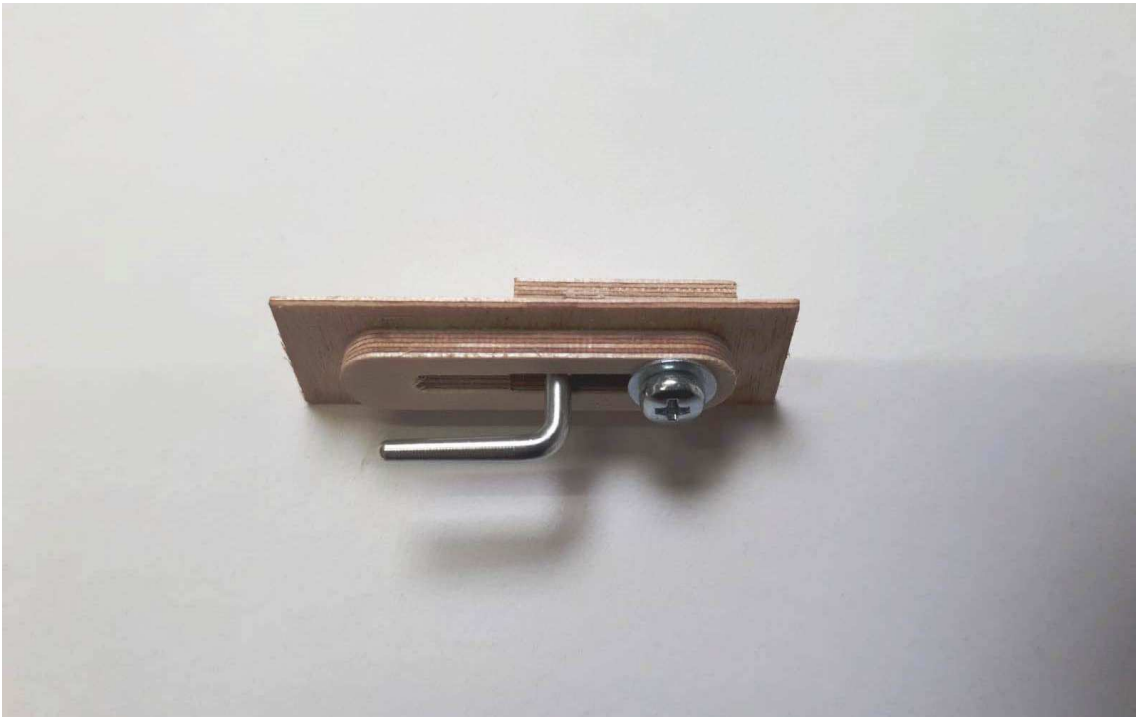
Fertig montierter verstellbarer Hochstarthaken
